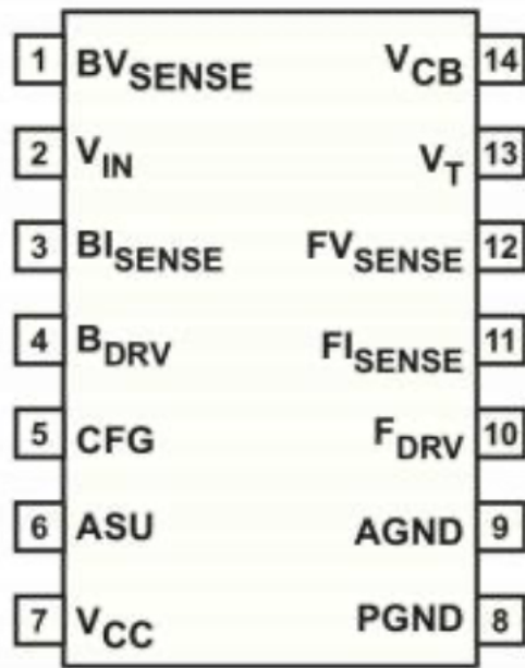
图4.1 14引脚SOIC封装
