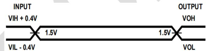
交流测试：按照测试电路测试所有交流参数。输入上升和下降时间以1ns/V驱动。
