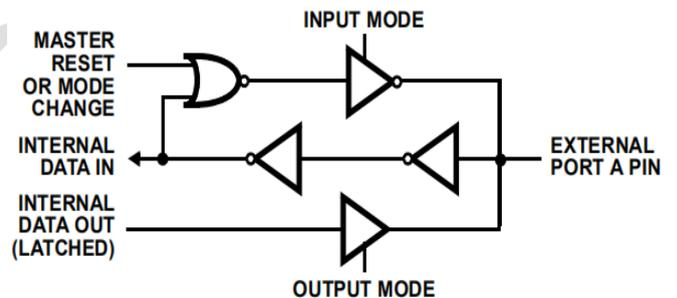
图2A. 端口总线配置
