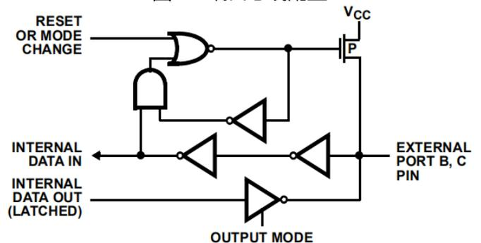
图2B. B和C端口的总线保持配置
